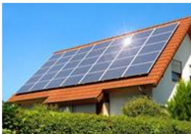
Constituído por painéis, módulos e equipamentos elétricos, o sistema fotovoltaico não exige um ambiente com alta radiação para funcionar. No entanto, a quantidade de energia produzida depende da densidade das nuvens, ou seja, quanto menos nuvens houver no céu, maior será a produção de eletricidade.
