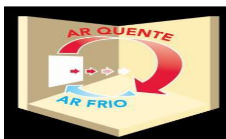
Figura 01 - Transmissão de calor por convecção
