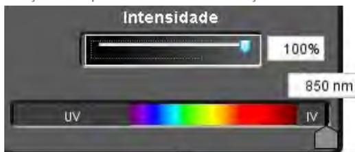
Configure a fonte para um potencial nulo (0,00V). Mova o cursor do comprimento de onda para a esquerda lentamente, varrendo todo o espectro.
