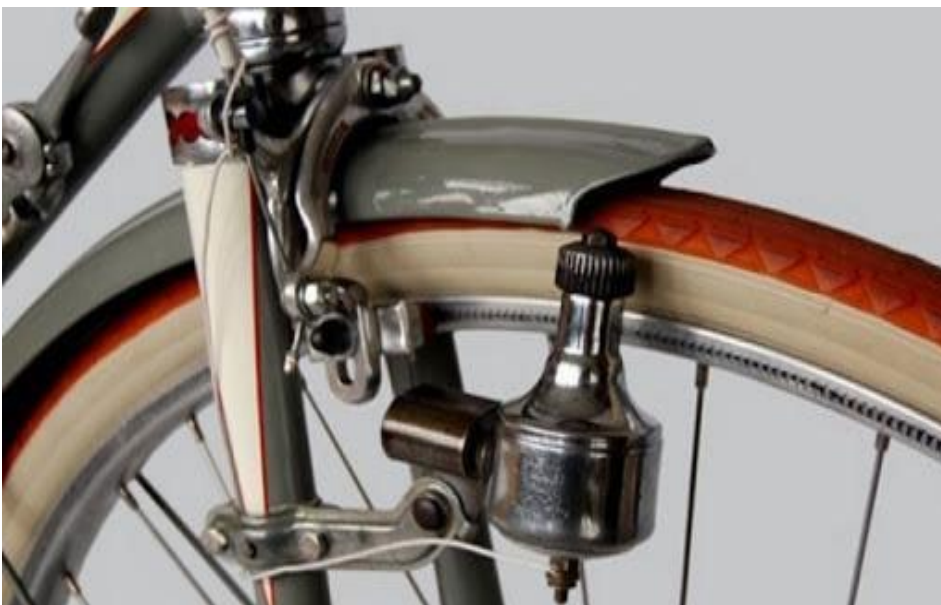
Figura 4 – Dínamo acoplado a uma bicicleta
